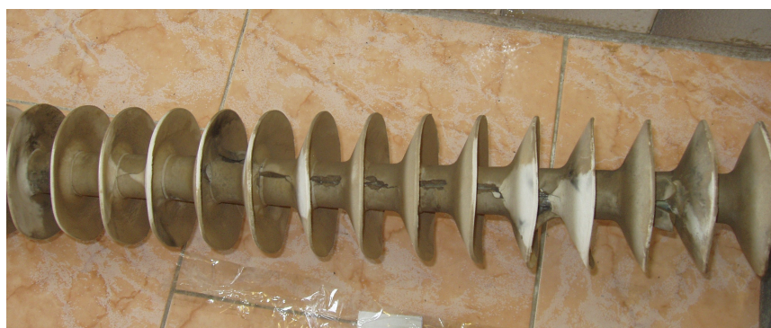
Рисунок 2 – Образование дендритов, треков на границе раздела, внутренняя эрозия защитной оболочки.
