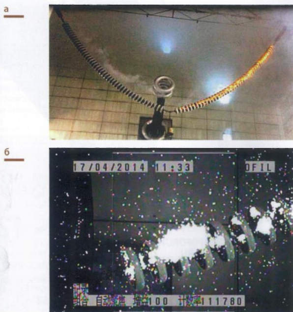
• Рис. 7. Перебегающие дуги на загрязненных изоляторах правой цепи (а) и их изображение на экране УФ-камеры (б)
