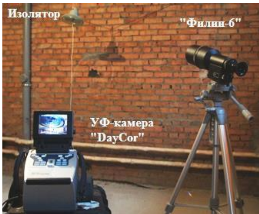
Рис. 4 – Размещение изолятора, УФ-камеры и дефектоскопа
